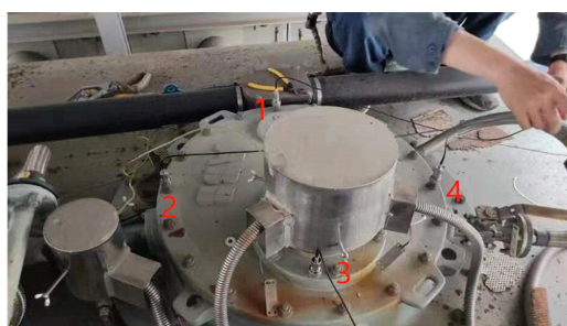
图 2 振动传感器安装图 Fig. 2 The installation diagram of vibration sensor
